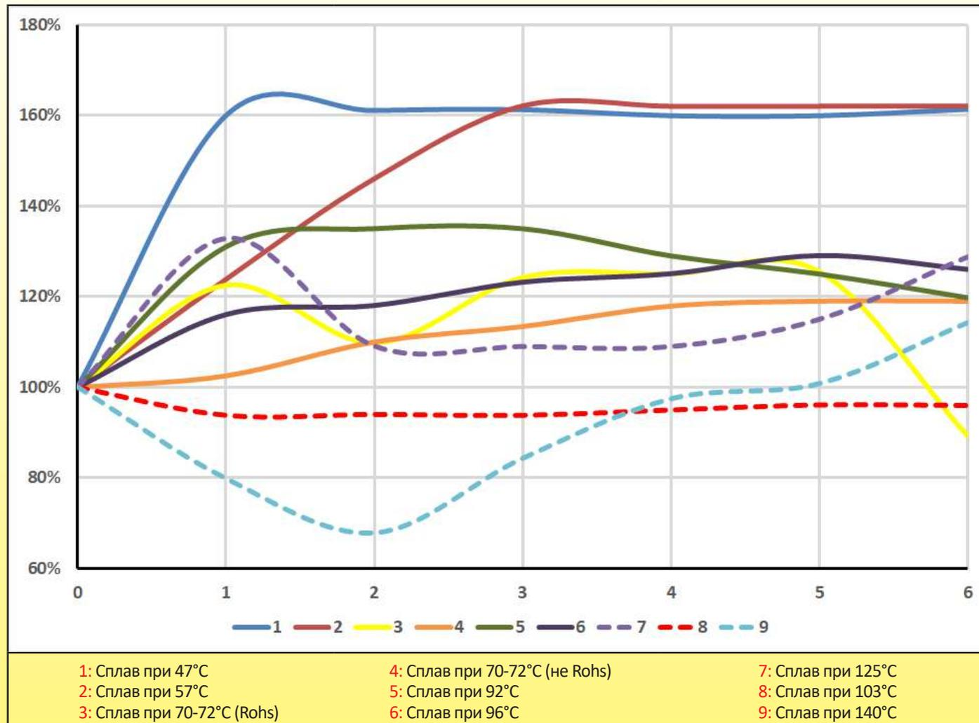
Приведенная выше кривая представляет собой изменение сопротивления в % от значения, измеренного сразу после сварки, в течение 6 недель для сварных образцов, изготовленных из различных легкоплавких сплавов, с площадью сварного шва 225 мм<sup>2</sup>. Значения измерены на нашем собственном испытательном оборудовании при медленной скорости протяжки 0,05 мм/мин.
