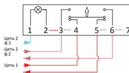
Последовательное соединение разомкнутых контактов (цепь 1) и параллельное соединение замкнутых контактов (цепь 2), при этом **пилотная лампочка на цепи 2** показывает, что питание включено. **(Эти 2 цепи могут иметь разное напряжение).**
