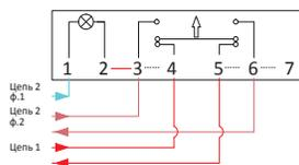
Последовательное соединение разомкнутых контактов (цепь 1) и параллельное соединение замкнутых контактов (цепь 2), при этом **пилотная лампочка на цепи 2** показывает, что питание включено. **(Эти 2 цепи могут иметь разное напряжение).**
