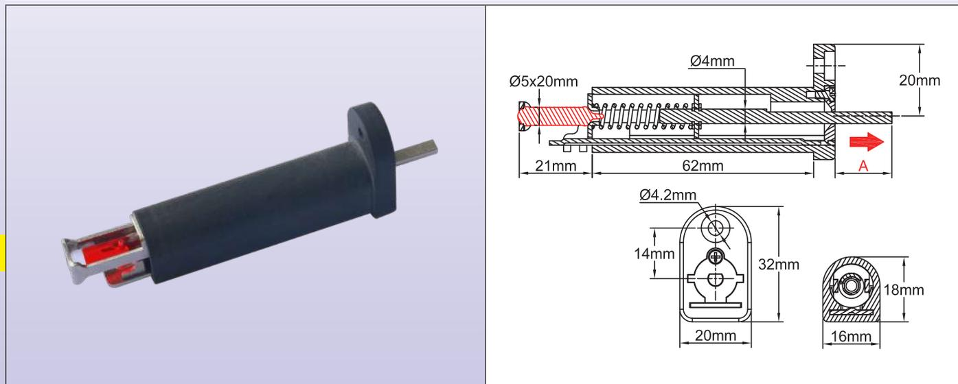
Эти механические термоприводы предназначены для закрытия противопожарных клапанов, используемых на вентиляционных каналах. Их **большое рабочее усилие разблокирует пружину, приводящую в действие клапан. Не требуется источника питания**, эти устройства отличаются особой простотой и надежностью.
