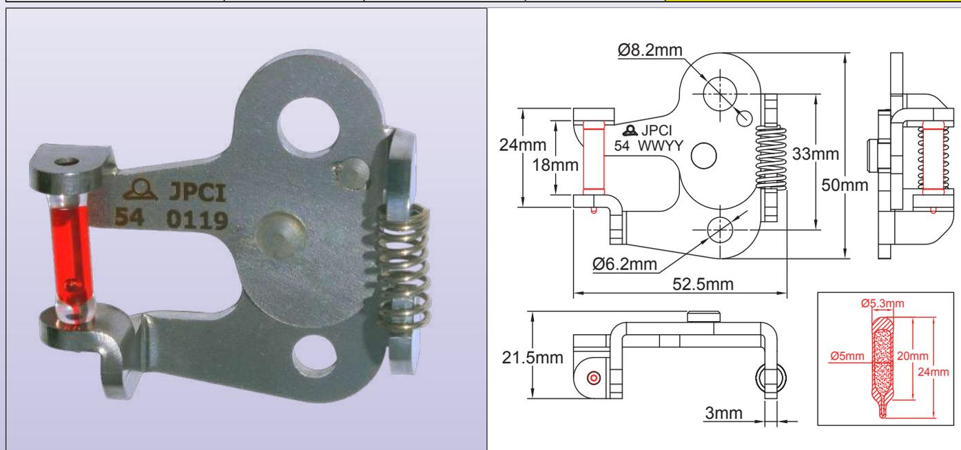
Изготовленные из оцинкованной стали толщиной 3 мм, эти редукционные механизмы совместимы с патронами 20x5 мм из термостекла. Их огромный коэффициент умножения снижает усилие, прилагаемое к патрону из термостекла, всего до 15% от усилия, прилагаемого к механизму. Замена стеклянного патрона проста и может быть выполнена без специальных инструментов.
