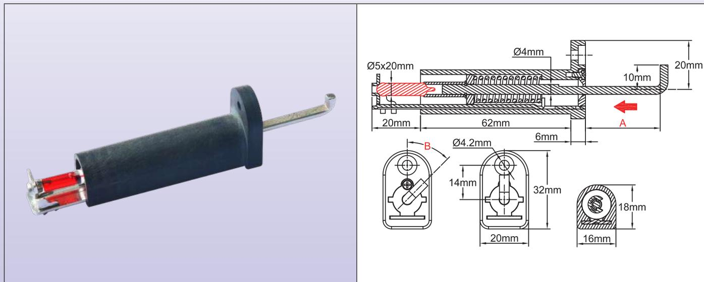
Эти механические термоприводы предназначены для закрытия противопожарных клапанов, используемых на вентиляционных каналах. Их **большое рабочее усилие разблокирует пружину, приводящую в действие клапан. Не требуется источника питания**, эти устройства отличаются особой простотой и надежностью. Они обязательны для всех противопожарных клапанов, соответствующих стандарту NF-S 61.937. **Поскольку термоматроны не подвержены ползучести, их периодическая замена не требуется.**
